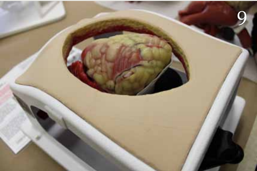
Илл. 10. Симулятор человеческой аорты с гидравлическим поршнем
