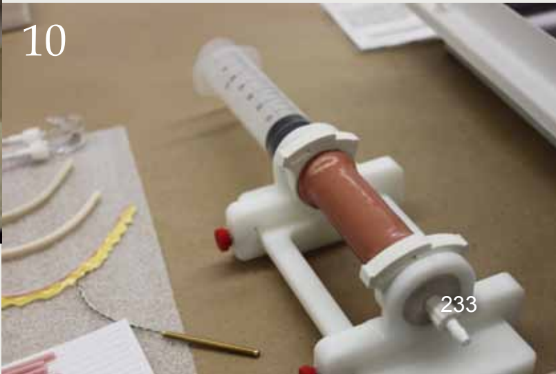
Илл. 10. Симулятор человеческой аорты с гидравлическим поршнем
